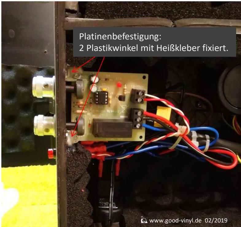
An die Platine habe ich zwei rechteckige Kunststoff-Winkel angepasst und mit zwei 4mm Schrauben befestigt. Die Winkel habe ich dann mit Heißkleber an der Innenwand festgeklebt. Die Platine habe ich relativ dicht an die Wand positioniert, damit die Achsen der beiden Potis weit genug aus dem Gehäuse ragten, um dort Die Bedienknöpfe anzuschrauben.
