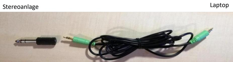
Bild: 3,5mm Klinkenstecker plus Adapter 6,3mm / 3,5mm (links im Bild)
